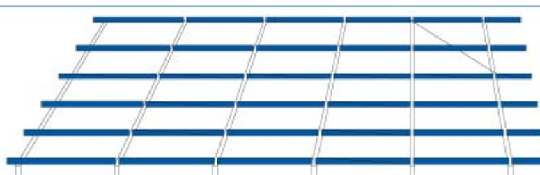
SYSTEM PŁATWI JEDNOPRZĘSŁOWYCH
